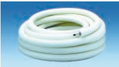
20mm厚ポリエチレンフォームを銅管O材を挿入、内部掃除後キャップシールし、コイルに巻き取る。
